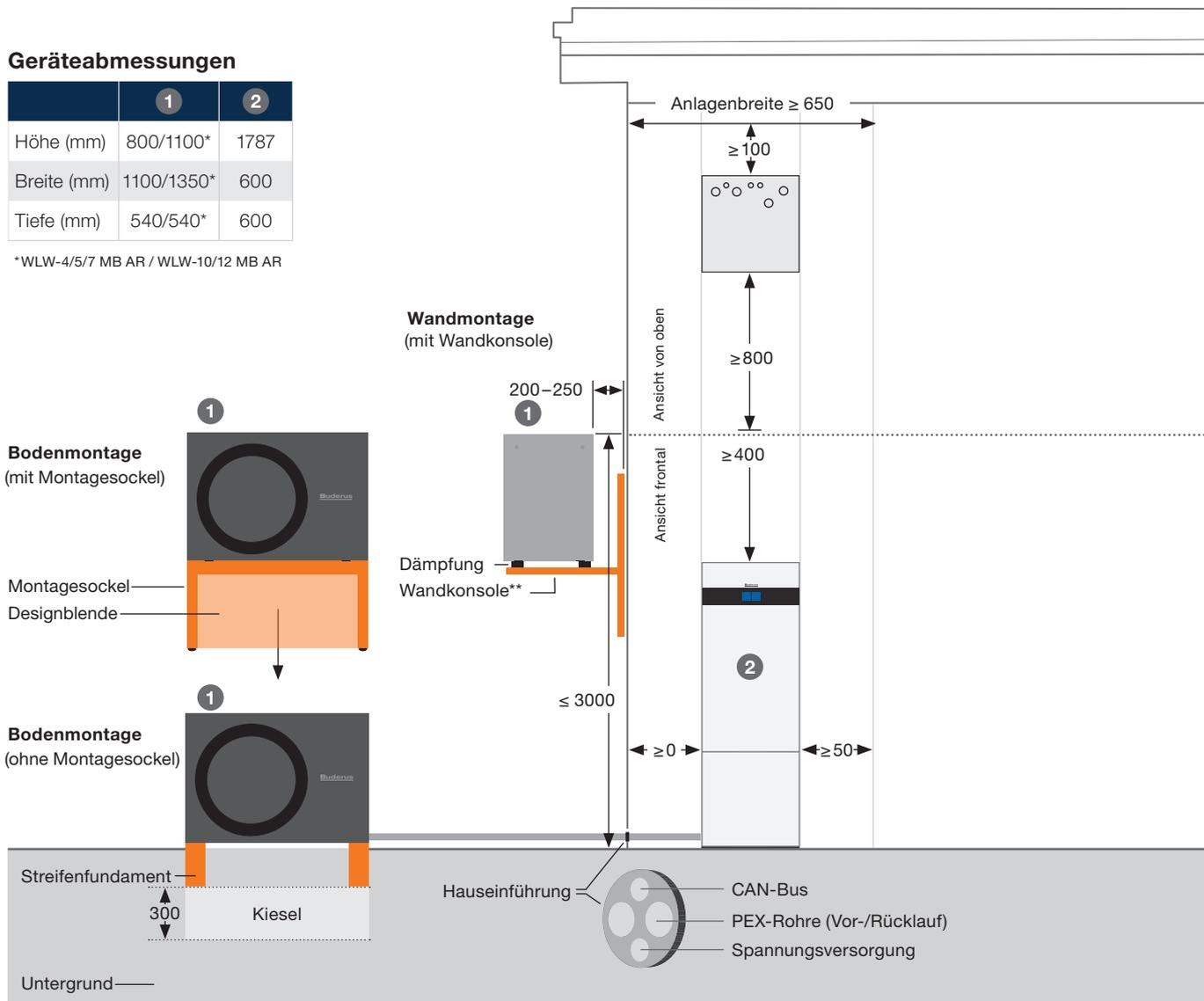
\*\* Für die Verwendung der Wandkonsole müssen die Montagefüße der WLW MB AR entfernt werden.
