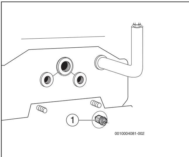
Bild 8 Wärmetauscher entlüften
