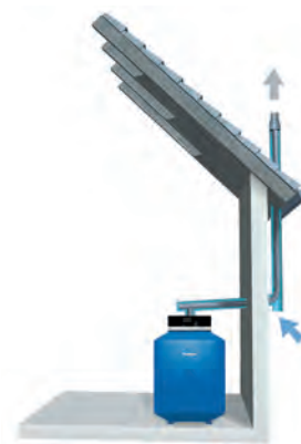
Raumluftunabhängige Aufstellvariante mit Rohr-in-Rohr-Kunststoff-Abgassystem entlang der Außenfassade.
