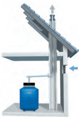
Raumluftabhängige Aufstellvariante mit eingezogenem Abgasrohr im Kamin.
