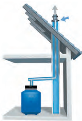
Raumluftunabhängige Aufstellvariante mit eingezogener Kunststoff-Abgasleitung im Kamin.
