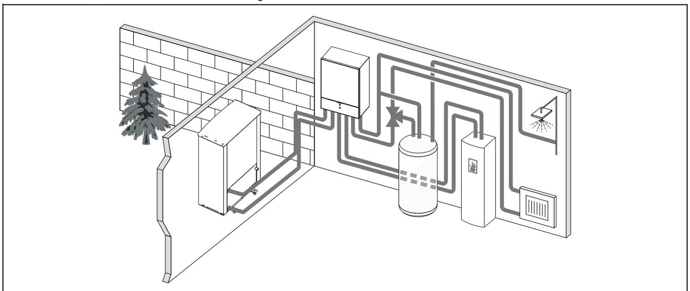
Bild 3 Wärmepumpe WLW196i.2 AR/IR, Inneneinheit IDU-..iB ohne elektrischen Zuheizung, externer Warmwasserspeicher und externer Zuheizung
