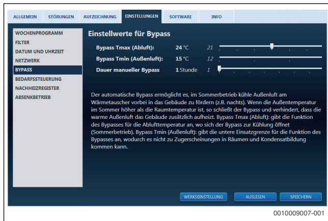
Bild 18 Einstellungen für den Bypass
