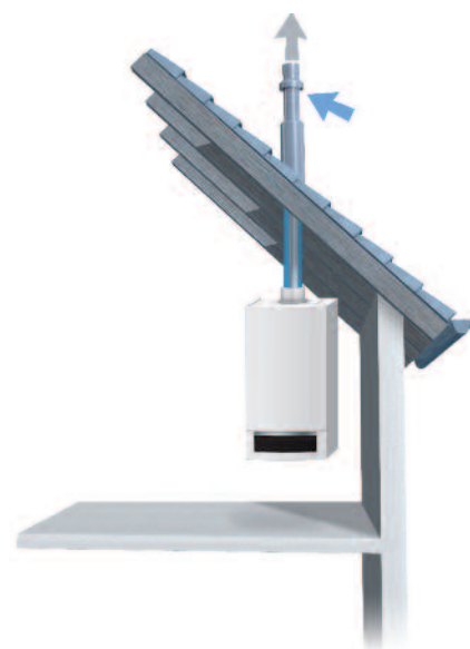
Raumluftunabhängige Aufstellvariante mit Abgasleitung über Dachinstallation
