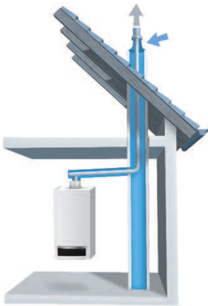
Raumluftunabhängige Aufstellvariante mit eingezogener Kunststoff-Abgasleitung im Schornstein (geeignet zur Luftansaugung über den Ringspalt des Schachtes)
