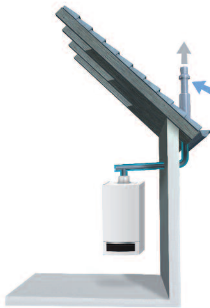
Raumluftunabhängige Aufstellvariante mit Rohr-in-Rohr-Kunststoff-Abgassystem (Außenfassade)
