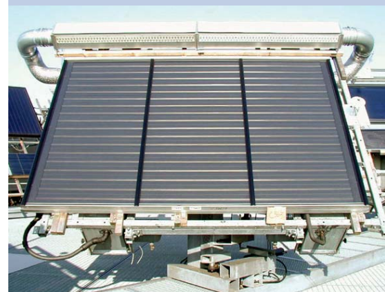
Kollektor am Norm-Außenprüfstand (SPF-Rapperswil)
