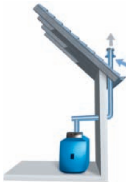
Raumluftunabhängige Aufstellvariante mit Rohr-in-Rohr-Kunststoff-Abgassystem
