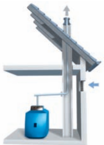
Raumluftabhängige Aufstellvariante mit eingezogenem Abgasrohr im Rauchfang ( nicht geeignet zur Luftansaugung)
