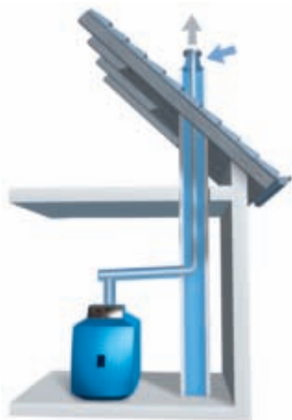
Raumluftunabhängige Aufstellvariante mit eingezogener Kunststoff-Abgasleitung im Rauchfang (geeignet zur Luftansaugung)
